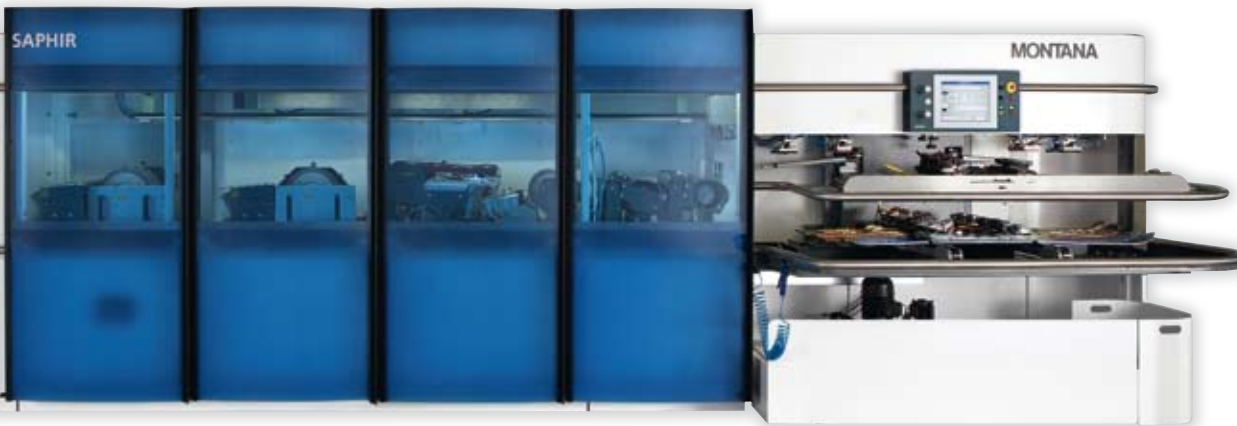
SAPHIR II W avec unité de fartage, séchage des skis automatique et la technologie PRO
